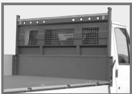
Cabinebescherming met ingewerkte ladderdrager
