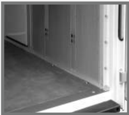
Kangaroo platform met in de bodem ingewerkte bindogen.
